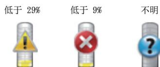
**注意：**如果实用程序未从打印机收到响应，将显示**未知墨粉**图像。
